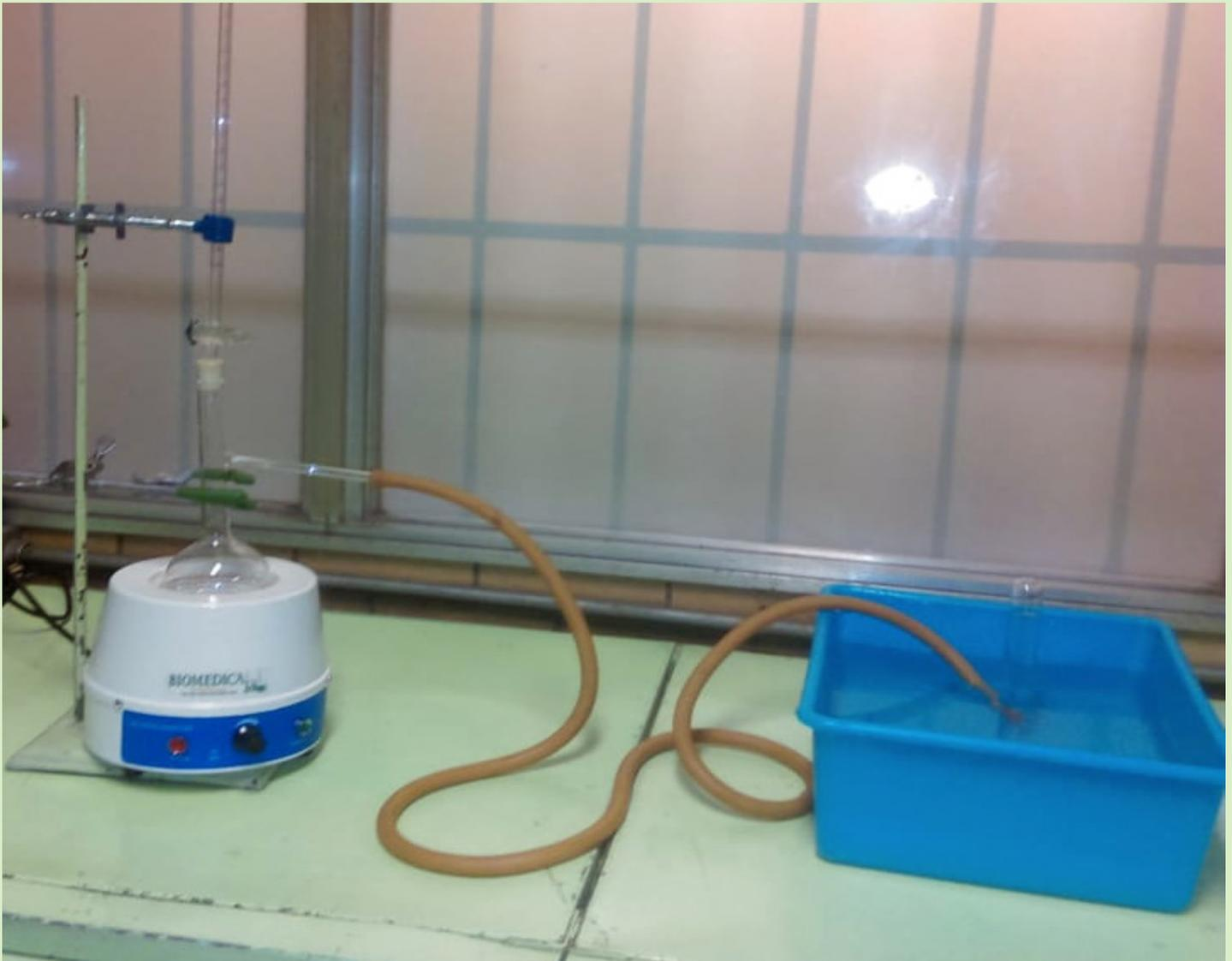
Figura 1.4. Aparato para la Obtención Experimental del Gas Acetileno, por Desplazamiento de Agua.
